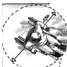
Si un tel espace est impossible à prévoir à l'intérieur pour cause de contraintes structurelles du local (par exemple présence de murs porteurs impossibles à déplacer?), alors la réglementation rend possible la localisation de cet espace de manoeuvre à l'extérieur du cabinet d'aisance mais à proximité de la porte d'accès.
