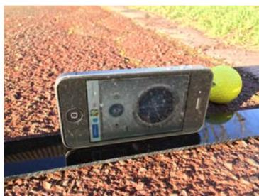
La dévers peut être facilement mesuré en repérant la ligne de plus grande pente à l'aide d'une balle et en utilisant une application adaptée sur un smartphone pour visualiser la déclivité.
