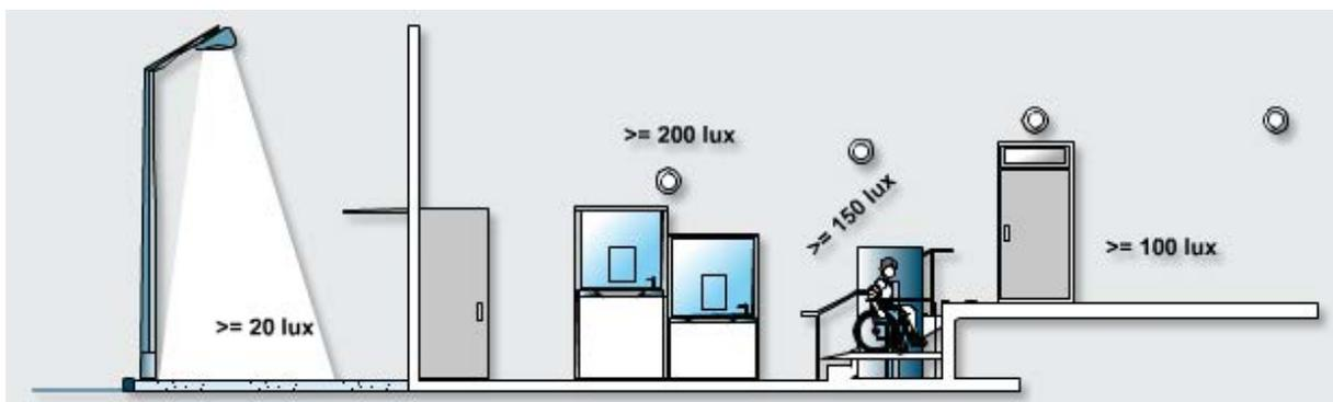
La notion d'éclairage renforcé correspond donc à plus de 150 lux ... ce qui n'est pas appréciable au jugé. Pour ce faire, il est possible d'utiliser un smartphone pourvu d'une application adéquate qui permet d'obtenir la valeur d'éclairage en lux.
