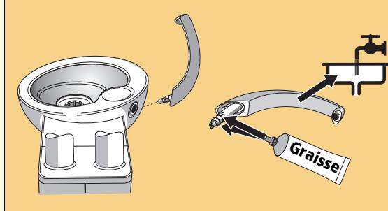
**Retirer et nettoyer le bec de remplissage ou, le cas échéant, l'adaptateur hydrocolloïde et graisser les joints toriques**
