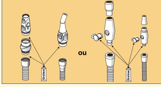
**Séparer les pièces d'aspiration au niveau de l'articulation, les nettoyer et graisser les raccords**
