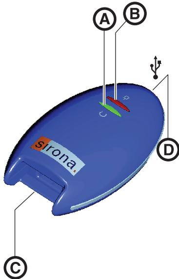
Le module USB se raccorde entre le capteur et le PC. Les données d'images sont transmises par le biais du module USB et du câble USB à un PC du commerce tournant sous Windows® où elles peuvent ensuite être utilisées avec le logiciel SIDEXIS XG.
