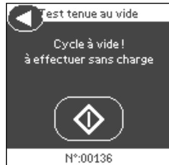
À la fin du cycle de test, un message sur l'écran informera du succès ou de l'échec de celui-ci. Si le test a échoué, vérifier, nettoyer ou remplacer le joint de porte, nettoyer les parois de la cuve et répéter le test. Si le test échoue à plusieurs reprises, contacter le SAV. Respecter les directives locales/nationales concernant la fréquence des tests.
