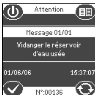
Lorsque le réservoir d'eau usée atteint le niveau maximum, le message suivant apparaît :
