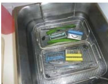
Bac à ultrasons rempli aux 2/3 de son volume au maximum
