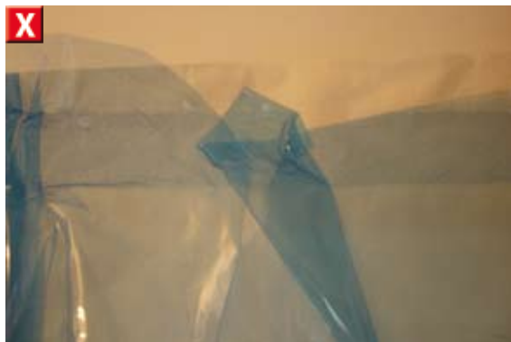
Soudure incorrecte car pliée (souvent due à un mauvais positionnement dans la soudeuse) : elle risque de rompre durant la stérilisation aboutissant à une absence de stérilité des DM
