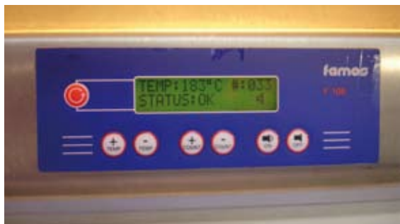
La température et la force d'écrasement conditionnent la qualité des soudures
