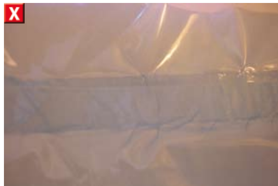
Soudure incorrecte due à un mauvais réglage de la température : elle risque de rompre durant la stérilisation aboutissant à une absence de stérilité des DM
