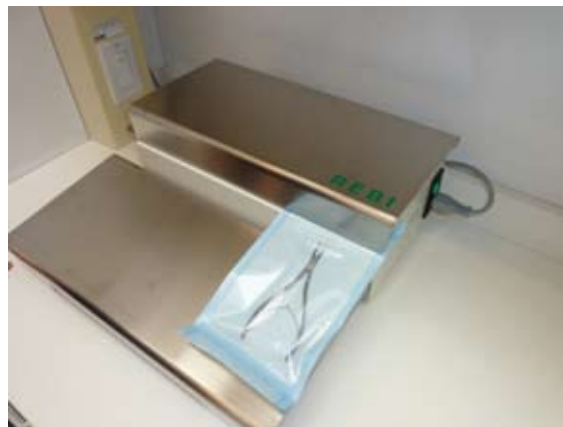
Les sachets ne doivent pas être trop remplis sinon ils se détériorent pendant la stérilisation
