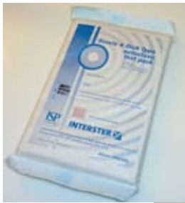
Paquet test conforme à la norme NF EN 867-4
