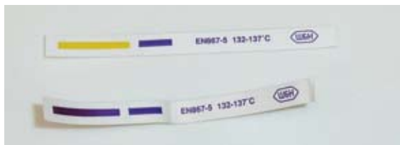
Virage de l'encre sur toute la longueur de la bandelette signant la réussite du test
