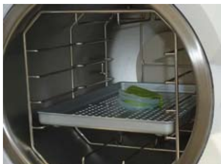
Système de test disposé au centre de la cuve
